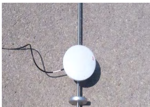
شکل ۷- نمایی صفحه‌ی دایره‌ای تعبیه شده در انتهای میله به منظور حرکت دادن میله بر روی سطح زمین
