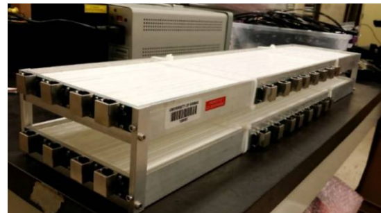
شکل ۱۲- نمونه اولیه آشکارساز میونون گمانه متشکل از لایه‌هایی از پلی‌استایرن میله‌ای و فوتودتکتورهای سیلیکون [۹۰].
