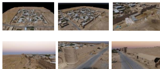
شکل ۷- قسمت هایی از مدل تشکیل شده از قلعه دولت آباد
