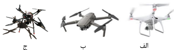
شکل ۵- الف: پهپاد فانتوم ۴ پرو، ب: پهپاد ماویک پرو، ج: پهپاد هگزاتور با دوربین Canon-M
