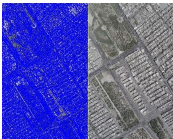
شکل ۳- الف) لایه هرم تصویر هوایی (Ultracam، ب) نتیجه قطعه بندی هرم تصویر
