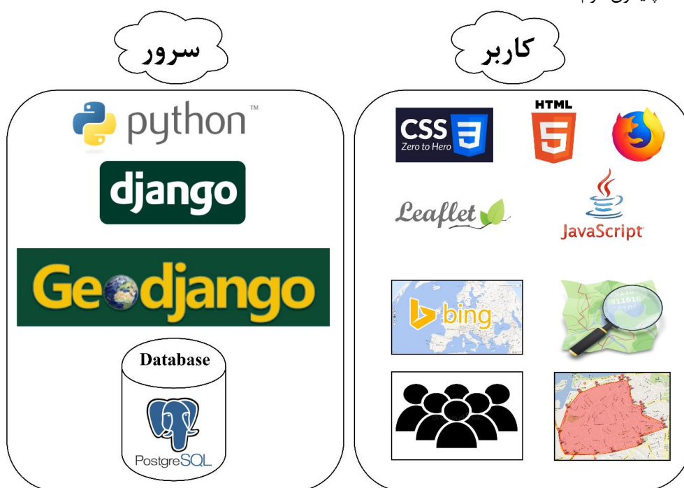
شکل ۸- معماری برنامه سرویس‌دهنده و سرویس‌گیرنده
