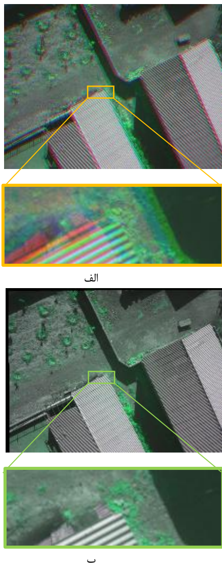
شکل ۶- هم مرجع سازی باندها در تصاویر چند طیفی؛ تصویر الف: اصلاح نشده، تصویر ب: اصلاح شده
