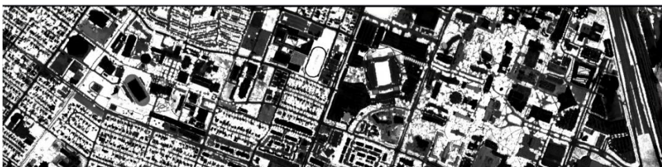
شکل ۴- ویژگی‌های استخراج شده برای داده فراطیفی شامل الف) NDVI، ب) modified red edge simple ratio index
