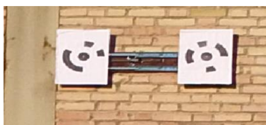
شکل ۱۱- الف) نشان‌دهنده تارگتها رو کولیس قبل از جابه‌جایی در اپک اول و ب) نشان‌دهنده تارگتهای جابجا شده در اپک دوم می‌باشد.
