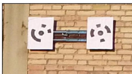
شکل ۶- کولیس و تارگتهای نصب شده روی آن به منظور ایجاد جابجایی
