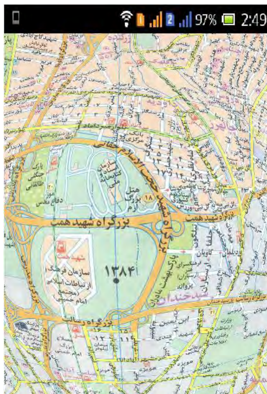
شکل ۱۱- نمایش کل نقشه با افکنش چشم‌مایی کروی (بزرگنمایی با مقیاس غیر یکنواخت)
