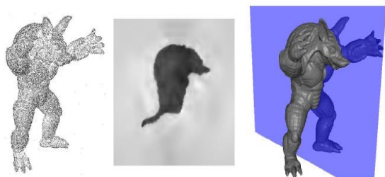
شکل ۱- تصویر چپ: ابر نقاط، تصویر وسط: نمایشی از تابع شاخص منطبق بر یک صفحه در فضای سه‌بعدی، تصویر چپ: سطح بازسازی شده به روش پواسن [۲۲]
