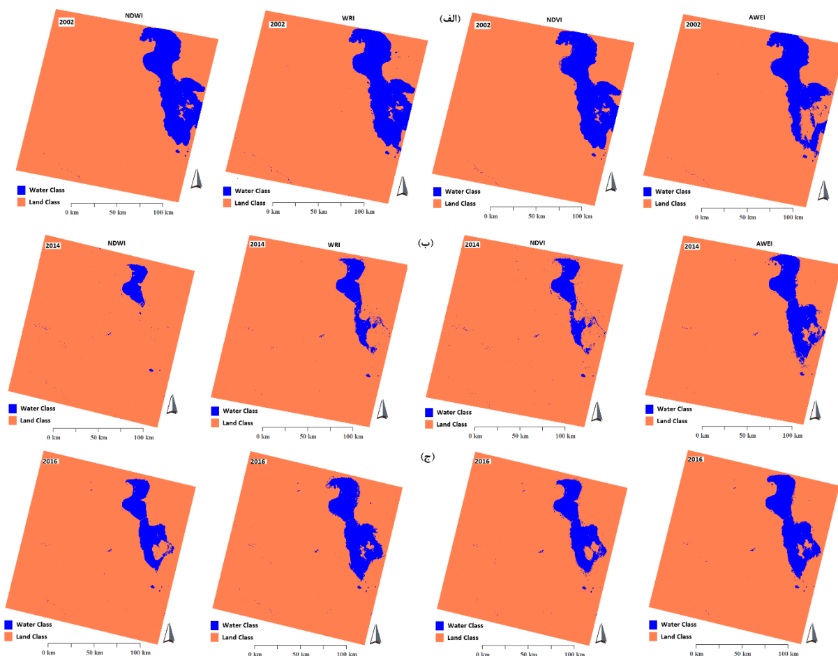
شکل ۴- نقشه تغییرات مساحت آب دریاچه ارومیه با استفاده از چهار شاخص استخراج مقدار کمی آب، شاخص نسبت آب (WRI)، شاخص اتوماتیک استخراج آب (AWEI)، شاخص اختلاف آب نرمال شده (NDWI) و شاخص اختلاف پوشش گیاهی نرمال شده (NDVI)، در سه دوره زمانی، (الف) دوره مینا سال ۲۰۰۲، (ب) سال ۲۰۱۴ و (ج) سال ۲۰۱۶
