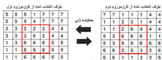
شکل ۱۰- عملگر جهش به صورت معاوضه ژنی دو بعدی
