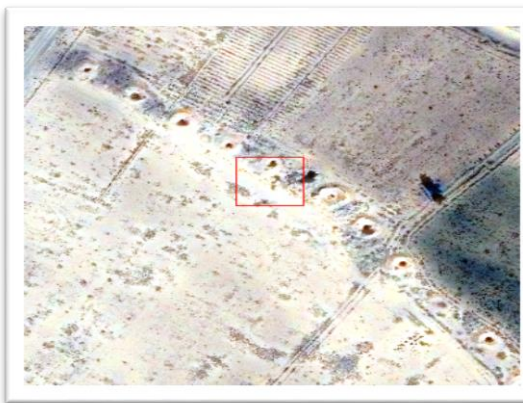
شکل ۴- ادغام عکس فتوگرامتری و تصویر ماهواره‌ای به روش اهلر (بالا) و بزرگنمایی شده آن (پایین)
