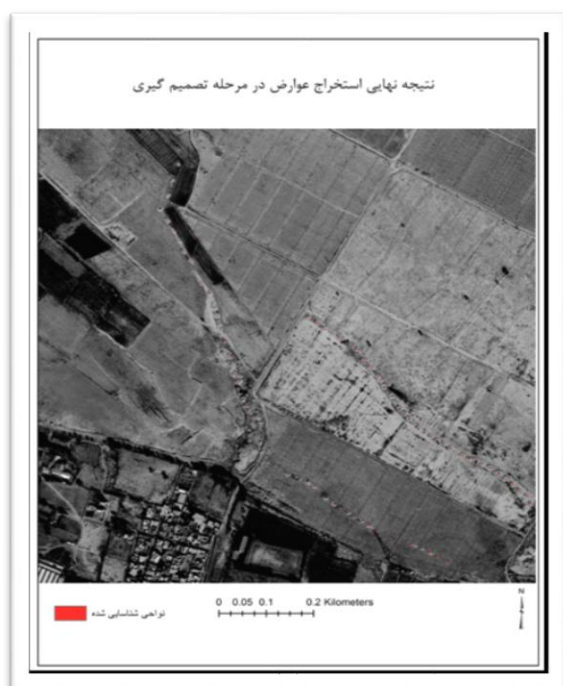
شکل ۲۰- رشته کاریز آشکارسازی شده از نتیجه ادغام پس از برهم‌نهی بر روی عکس فتوگرامتری
