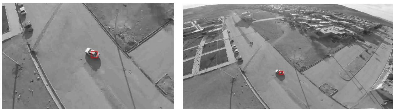
شکل ۸- هدف متحرک آشکارسازی شده با استفاده از روش پیشنهادی
