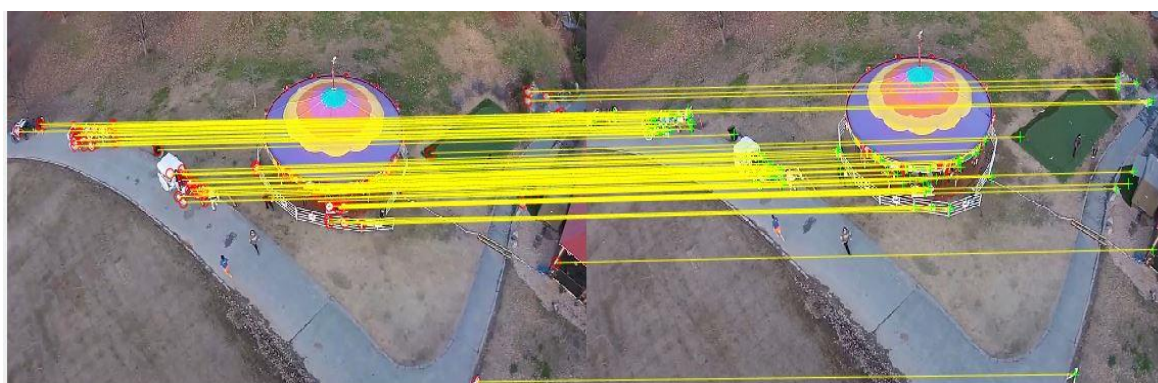
شکل ۹- نقاط متناظر با استفاده از الگوریتم SURF بهبود داده شده
