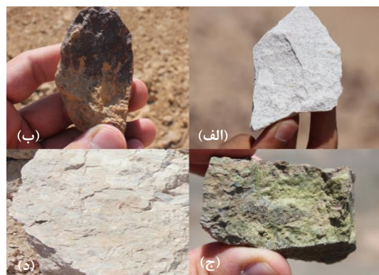
شکل ۱- نمایی از نمونه‌های سنگی برداشت شده در منطقه مورد مطالعه، الف) آلونیت، ب) همتایت، ج) اپیدوت، د) کائولینیت
