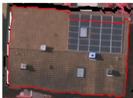
شکل ۱۲- عدم موفقیت مدل لبه مبنای در شناسایی مرز ساختمان های دارای بافت خاص
