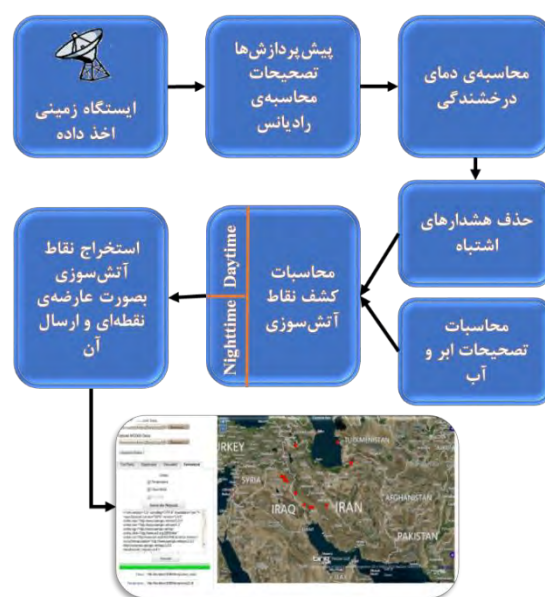
شکل ۴- زنجیره‌ی پردازش‌های تشخیص نقاط آتش‌سوزی
