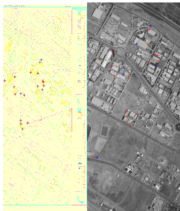
شکل ۷- توزیع نقطه کنترل (قرمز) و نقطه چک (آبی) بر روی تصویر و نقشه
