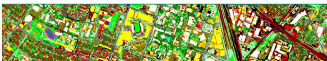
شکل ۹- تصویر حاصل از ادغام داده های فرطیفی و لیدار تحت روش پیشنهادی سیستم طبقه بندی کننده چندگانه فازی
