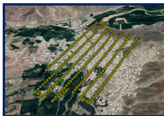
شکل ۲- مسیر حرکت پهپاد و ایستگاه‌های تصویربرداری بر روی تصویر ماهواره‌ای
