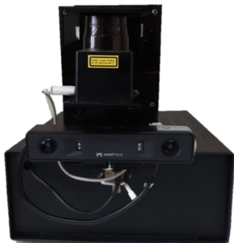
شکل ۱۱- سیستم طراحی شده شامل فاصله‌یاب دوبعدی، دوربین استریو و سروموتور
