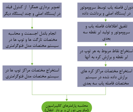
شکل ۳- فلوجارت کالیبراسیون با استفاده از ابر نقطه سه بعدی
