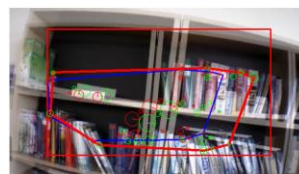
شکل ۳- نمونه ای از آشکارسازی ناقص موانع به صورت convex hull قرمز رنگ [۱۴]
