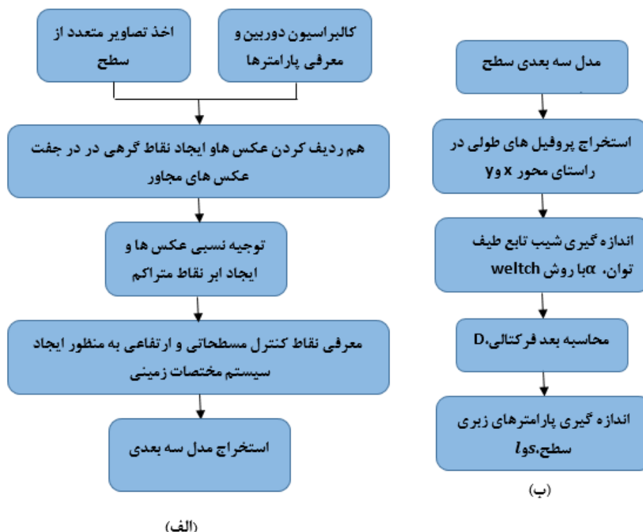
شکل ۱- متدولوژی اندازه گیری پارامترهای زبری سطح. الف: روش تهیه مدل سه بعدی با استفاده از روش فتوگرامتری زمینی و استخراج مدل سه بعدی. ب: روش اندازه گیری پارامترهای زبری با استفاده از پروفیل های طولی استخراج شده از مدل سه بعدی شامل (rms-height) و (l طول همبستگی)
