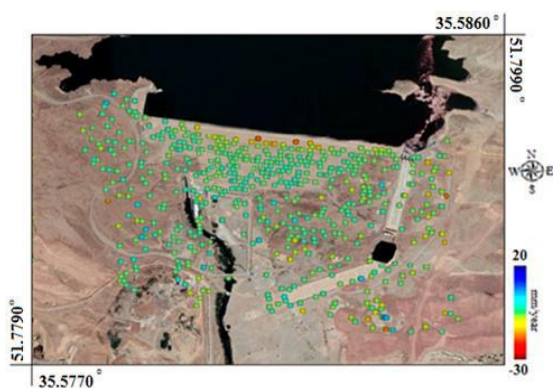
شکل ۱۰- نقشه جابجایی بدست آمده برای سد ماملو با استفاده از تصاویر سنجنده S-1A در حالت Descending
