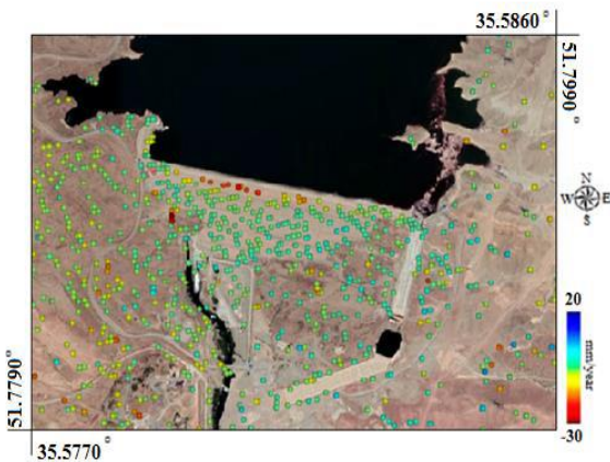
شکل ۶- نقشه جابجایی بدست آمده برای سد ماملو با استفاده از تصاویر سنجنده S-1A در حالت Ascending
