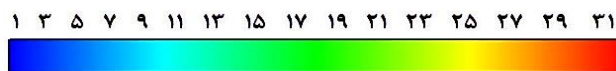
شکل ۵ - راهنمای مقادیر رنگی نتایج FDS (هر مقدار بیان کننده حداکثر فاصله (متر) است که در ناحیه رنگی مربوطه، امکان تشخیص یک شی وجود دارد).
