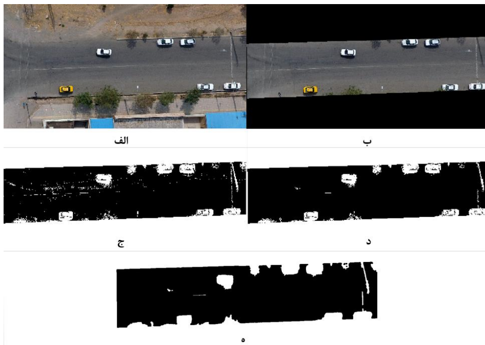
الف) تصویر اصلی ب) اعمال ماسک جاده ج) اعمال فیلتر حدآستانه د) حذف عوارض کوچک توسط تابع حذف عوارض منفرد ه) نتیجه نهایی پس از اعمال فیلتر بستن مورفولوژی
